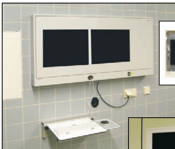
Visionneuse d'images digitales Xray avec 2 écrans montés au mur
