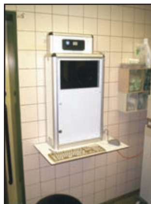
Sana.Panel Wandmontage mit elektromotorischem Lift
